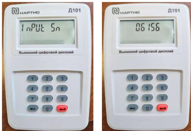
По завершению ввода заводского номера счётчика электрической энергии, нажмите клавишу «Ввод» и дождитесь выполнения синхронизации информации выносного цифрового дисплея и счётчика э/э.
