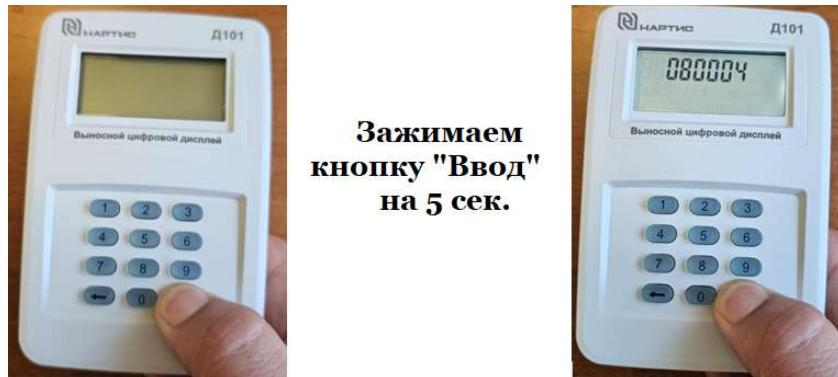
Шаг 3. В появившемся приглашении введите полный заводской номер прибора учёта электрической энергии, к которому выполняется привязка цифрового дисплея Нартис Д101:
