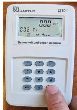
Шаг 2. Используя цифровую клавиатуру дисплея, наберите на клавиатуре код «1111» и нажмите клавишу «Ввод»,
