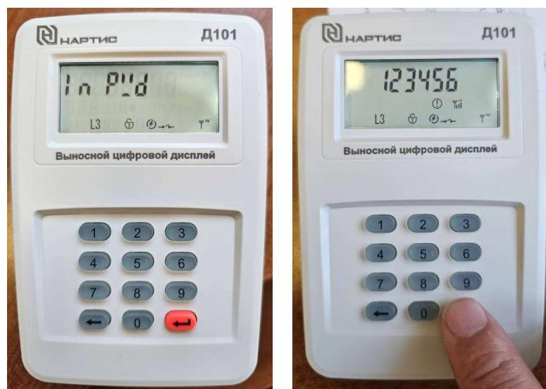
Шаг 4. На предложение ввода заводского номера счётчика электрической энергии, введите полный номер счётчика э/э (обратите внимание, что ширины экрана не хватит для отображения всего вводимого номера счётчика, для этого используется прокрутка строки ввода).
