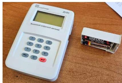
Шаг 2. На 5 секунд зажимаем клавишу «Ввод» на выносном цифровом дисплее Нартис Д101
